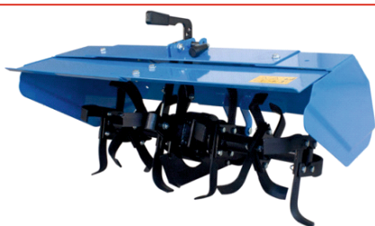
Freză BTA-RT60F COD: BTA-RT60F Lățime de lucru 600 mm Adâncime 200 mm
