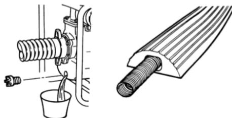
Quando non utilizzate più la pompa, svuotare l'acqua dal corpo della pompa. L'acqua determina la formazione di ruggine del rotore e durante l'inverno gela e danneggia i componenti della pompa (può rompere il corpo della pompa).
