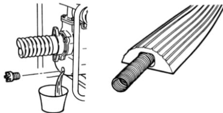
Amikor nem használja a szivattyút, távolítsa el annak belsejéből a vizet. A víz a rotor rozsdásodását idézi elő, valamint telente megfagy, ezáltal súlyosan károsíthatja a szivattyú alkatrészeit (akár szét is feszítheti a szivattyú testét).
