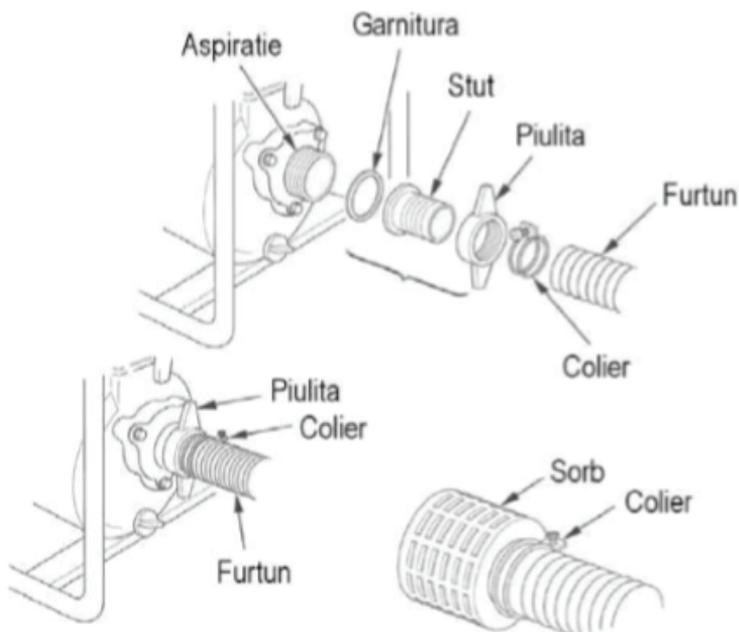
Il tubo di aspirazione non deve essere più lungo del necessario. La prestazione della pompa è ottima, qualora i tubi siano più corti. Fissare il collare del raccordo sul tubo di aspirazione per prevenire la penetrazione dell'aria e la perdita dell'aspirazione. Verificare che la guarnizione di tenuta del raccordo sia in ottimo stato.
