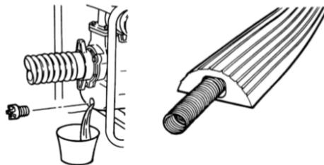
Cind nu mai utilizati pompa, evacuatii apa din corpul acesteia. Apa determina ruginirea rotorului si iarna aceasta ingheata si deterioreaza componentele pompei (poate sparge corpul pompei).
