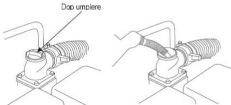
Qualora la motopompa sia utilizzata senza l'acqua, la guarnizione meccanica può danneggiarsi.
