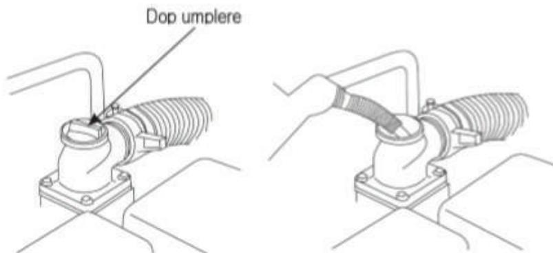
**Daca motopompa este utilizata fara apa garnitura mecanica se poate distruge. Daca motopompa a fost utilizata fara apa opriti-o imediat si lasati-o sa se raceasca inainte de amorsare.**
