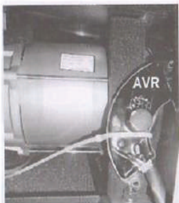
Figura B – Căutați locația AVR (regulator automat de tensiune). Este posibil ca acest element să trebuiască să fie schimbat când se uzează excesiv.
